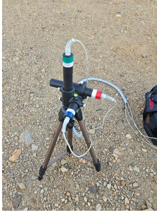
Şekil 2. Manyetik alanın üç bileşenin ölçmek için kullanılan düzenek.
